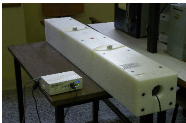
Figura 6. Medida de la interferencia de las emisiones gamma de dos fuentes de ^{226}\text{Ra} en el detector de neutrones N-27a.
