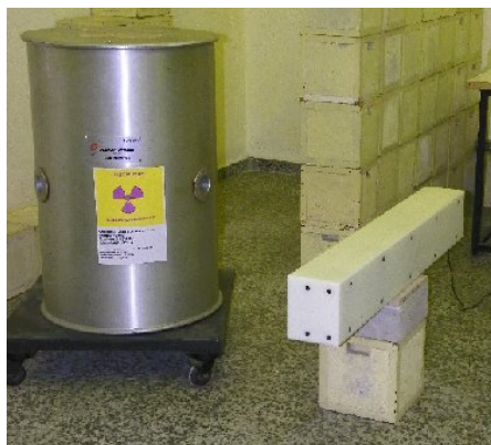
Figura 3. Contenedor Howitzer con la fuente de neutrones de ^{241}\text{Am}+\text{Be} de 69 GBq.
