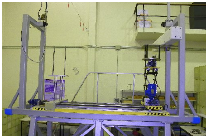
Figura 4. Bancada con la fuente de neutrones de ^{241}\text{Am}+\text{Be} de 104 GBq.
