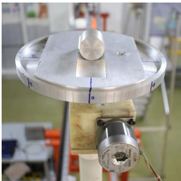
A medição da emissão de nêutrons ocorre em função do ângulo polar  $\theta$  entre a direção do detector e o eixo da fonte, como pode ser observado na figura 2. Dessa forma, a medição de anisotropia é realizada a partir do alinhamento horizontal da fonte com o detector a uma distância de 2 metros<sup>[4]</sup>.
