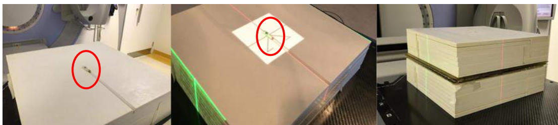
Figura 7: Posicionamento folha OSL de \text{CaF}_2 (identificada por círculos vermelhos) para validação da dose planejada.
