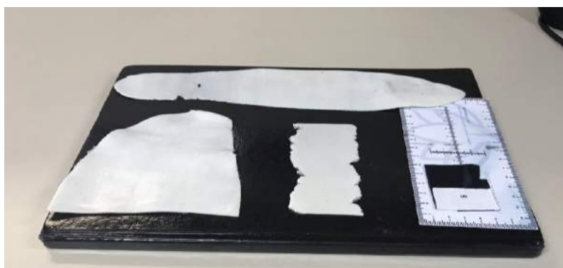
Figura 5: Folhas detectoras OSL de CaF 2 produzidas na UTFPR-CT.
