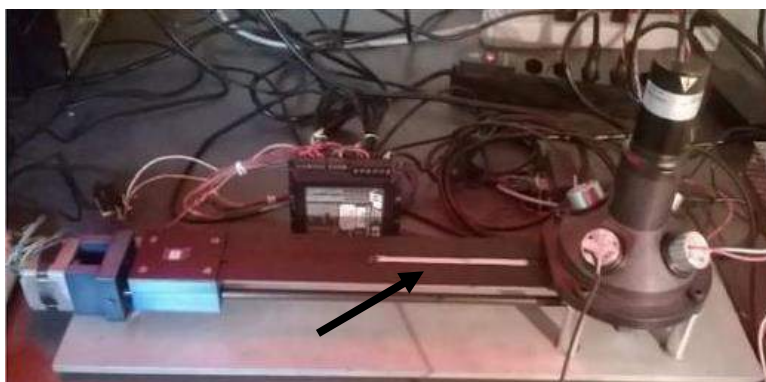
Figura 6: Leitor OSL linear do IFUSP e fita detectora OSL de \text{CaF}_2 identificada (seta preta).
